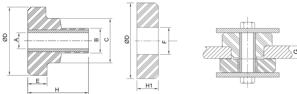
Supporti cabina particolarmente efficaci per l'isolamento dalle vibrazioni di motori, cabine di guida ed altre unità accessorie. Impiegati generalmente per supportare cabine e motori di macchine agricole, garantiscono un'ottima attenuazione delle vibrazioni ed un notevole assorbimento di carichi continui e shock.
